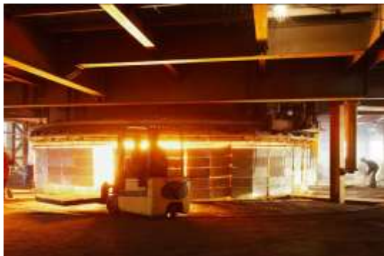
Руднотермическая печь Серовского завода ферросплавов
