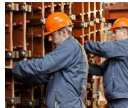
Сборка активной части трансформатора
